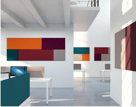
Les panneaux acoustiques accrochés au mur ou suspendus au plafond absorbent énormément les bruits et suppriment les échos. Il n'est toujours nécessaire de recouvrir l'ensemble des surface.
